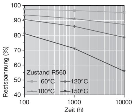
Restspannung in Abhängigkeit von Betriebstemperatur und Belastungsdauer. Gemessen an thermisch entspannten Bandproben nach der Ringmethode. Probenlage parallel zur Walzrichtung. Werte extrapoliert nach F. R. Larson, J. Miller, Trans ASME74 (1952) 765-775.
