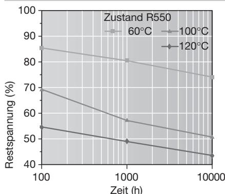
Restspannung in Abhängigkeit von Betriebstemperatur und Belastungsdauer. Gemessen an walzharten Bandproben nach der Ringmethode. Probenlage parallel zur Walzrichtung. Werte extrapoliert nach F. R. Larson, J. Miller, Trans ASME74 (1952) 765-775.
